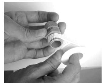
Figure 21 : Pose du joint téflon sur le porte-sonde.
