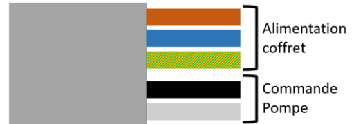
Figure 11 : Câble d'alimentation coffret OKLYN
