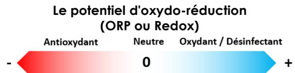
Le potentiel d'oxydoréduction, ou ORP, est une mesure qui indique le degré auquel une substance est capable d'oxyder ou de réduire une autre substance. L'ORP est mesuré en millivolts (mV).
