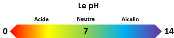
Le pH est une mesure de l'acidité ou de l'alcalinité d'une solution. Il fournit une valeur sur une échelle de 0 à 14 où 7 est neutre. Plus on se rapproche de 0, plus une solution est acide, et plus on se rapproche de 14, plus la solution est alcaline.
