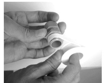
**Figure 21 : Pose du joint téflon sur le porte-sonde.**
